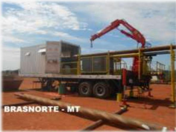
1 RECUPERAÇÃO DA COLUNA DE PERFURAÇÃO ROSCAS API NO CAMPO AO LADO DA PLATAFORMA, ECONOMIA COM DESMOBILIZAÇÃO DOS EQUIPAMENTOS A UM CENTRO DE USINAGEM;
